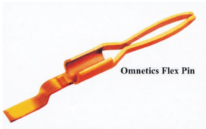
テーパ状の先端構造がソケットに挿入される時にアライメントを補正し挿抜力が大きくなるのを防いでいます。
