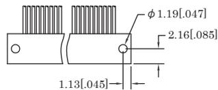
固定取付け用穴は 3 個のコンタクト穴用のスペースを使用
