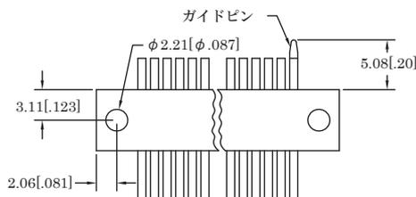
固定取付け用穴は3個のコンタクト穴用のスペースを使用
